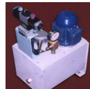
Насосная установка ГППД прижимного устройства
