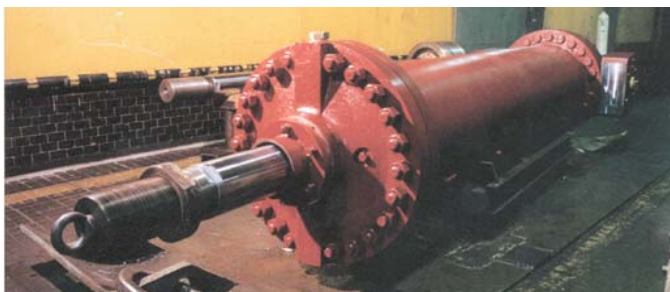
Гидроцилиндр ГППД разводного раскрывающегося моста
