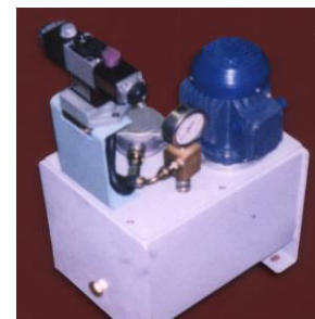
Насосная установка ГППД прижимного устройства
