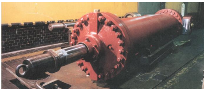
Гидроцилиндр ГППД разводного раскрывающегося моста
